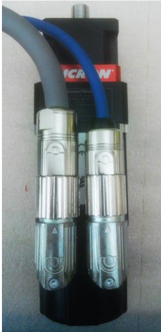
Motor cable hookup
